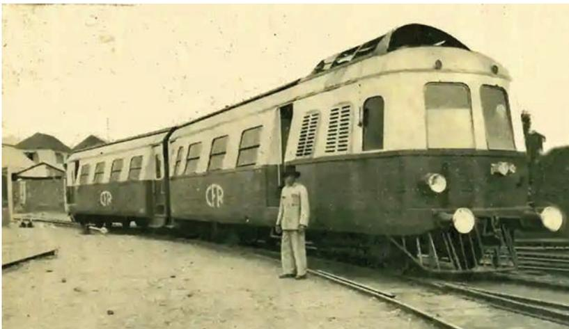
*Très belle automotrice articulée Brissonneau et Lotz mise en service officiellement en 1940 sur la ligne de La Réunion. La forme de la caisse est dictée par le gabarit très restreint des tunnels du réseau réunionnais.*
